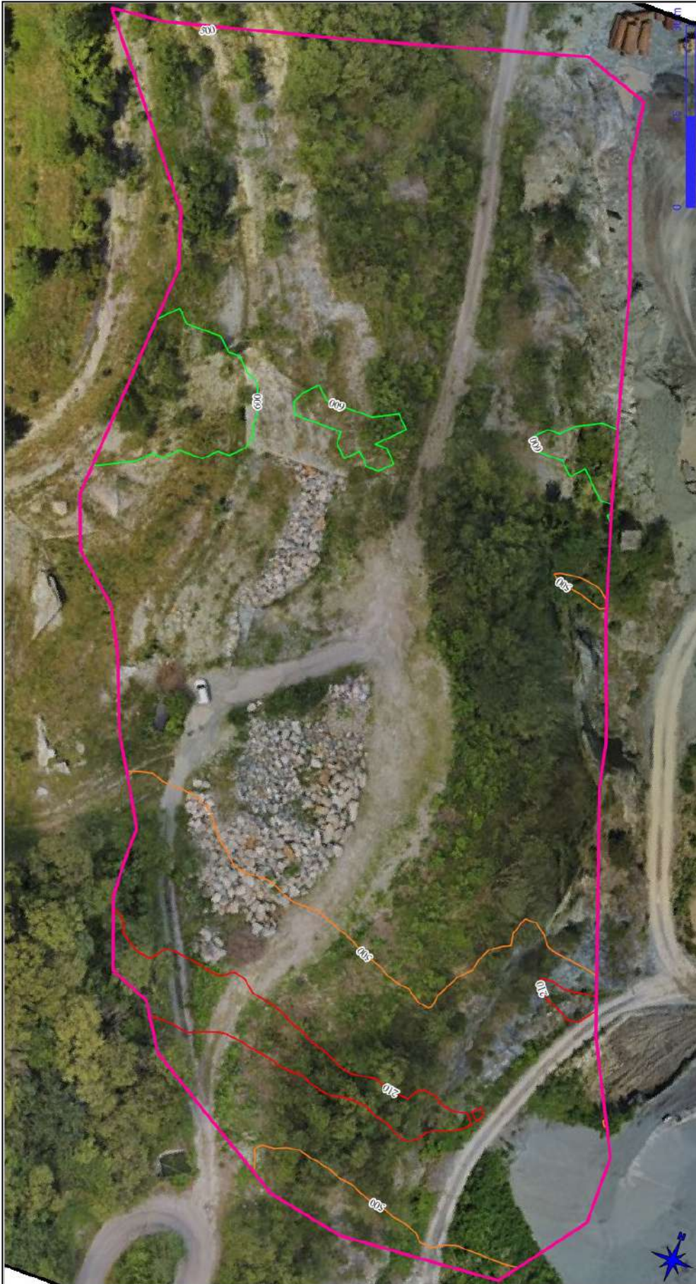
Reach probability (curve di livello) – 1mc – dettaglio area di cava con indicate le ore annue di esposizione massima per un individuo sul mezzo
