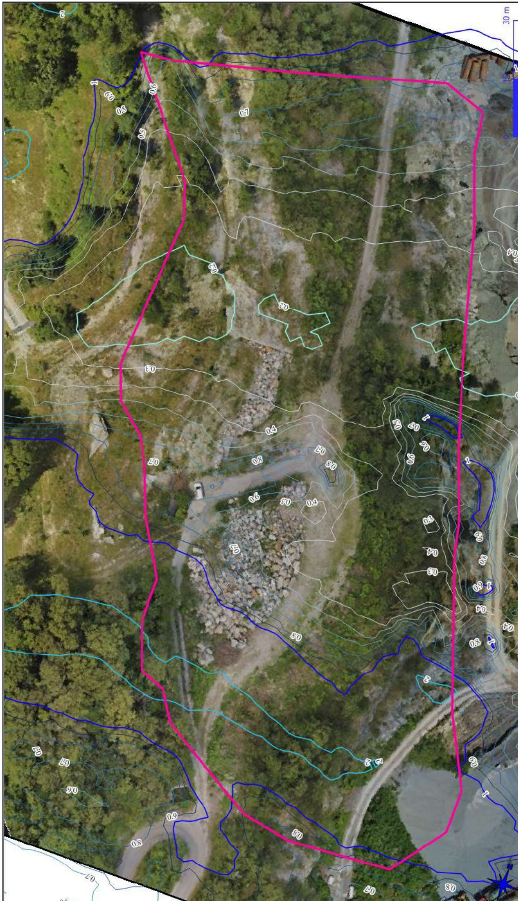
Reach probability (curve di livello) – 1mc – dettaglio area di cava – rilievo Geoform
