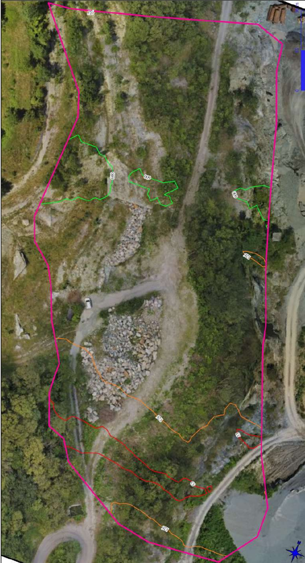
Reach probability (curve di livello) – 1mc – dettaglio area di cava con indicate le ore annue di esposizione massima per un individuo a piedi
